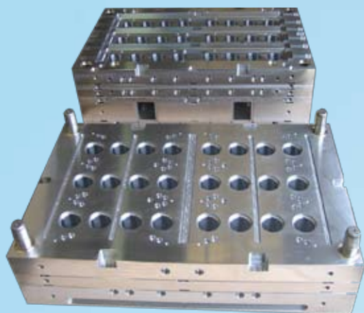
Anwendungsbereich: 24-Fach Formaufbau - Kosmetik Werkstoffe: 1.2312 Abmessung: 960 x 620 mm
