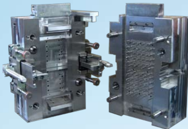
Anwendungsbereich: 2-Fach Formaufbau - Verpackung Werkstoffe: 1.2085 Abmessung: 500 x 340 mm
