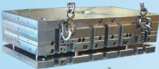
Anwendungsbereiche: vorgeschruppte Einsatz - Automobil Werkstoffe: ADINOX 47 (Thyssen) Abmessung: 300 x 300 (1 mm Übermaß)
