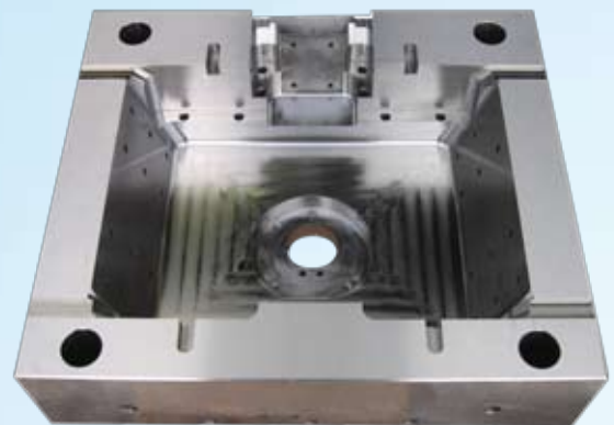
Anwendungsbereiche: Formplatte - Sonstiges Werkstoffe: 1.2085 Abmessung: 596 x 540 mm
